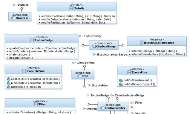
Les piliers de chargement sont des entités relativement autonomes qui bénéficient d'une connexion directe au SI Autolib. Le composant contrôleur d'un pilier de chargement peut prendre trois états :
